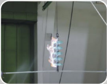
雷电冲击干耐受电压试验 Dry lightning impulse voltage test
