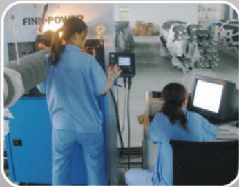
使用监视器来压接 Crimping uses sensors to monitor
